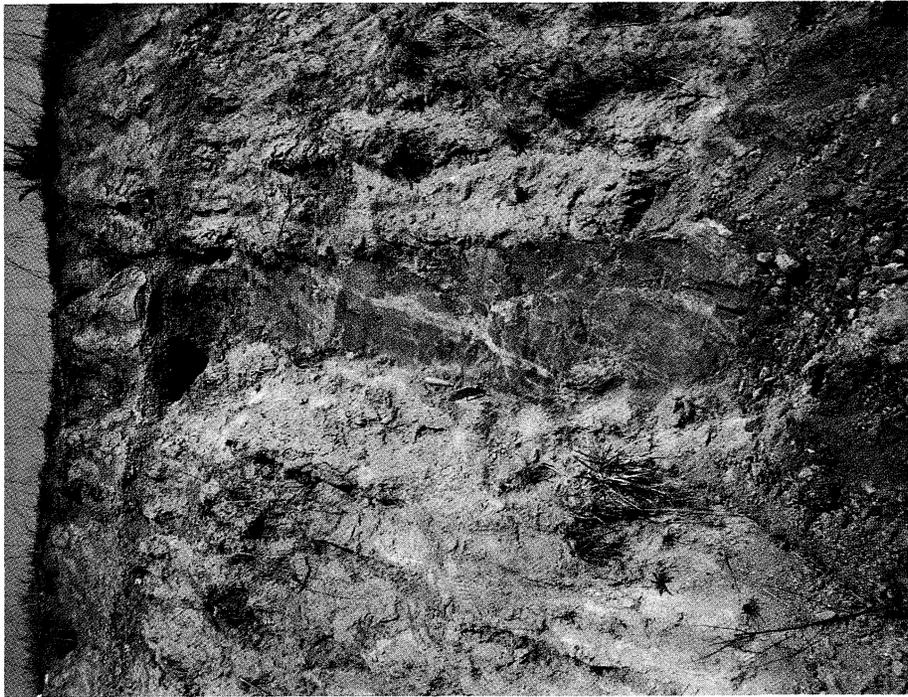
Fig. 6 - *Unità CIL 6*. Si osservino, dall'alto, gli orizzonti II B21 t, II B22 cn, II B23 g, III B1 e III B21 tx. (v. figg. 4 e 5 e la spiegazione nel testo).
