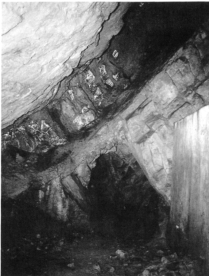
Fig. 7 - Banco di siderite coltivato nel cantiere «La Longa», Pisogne.
